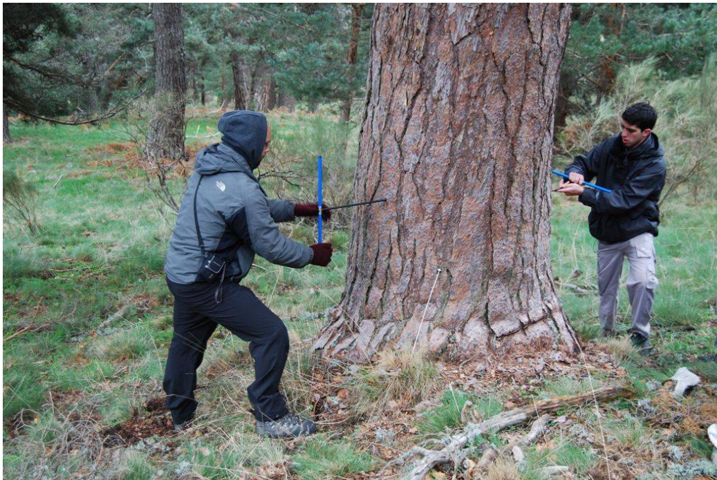
Muestreo de un pino silvestre centenario con barrena de Pressler, Navarredonda de Gredos, España. / Mar Génova
