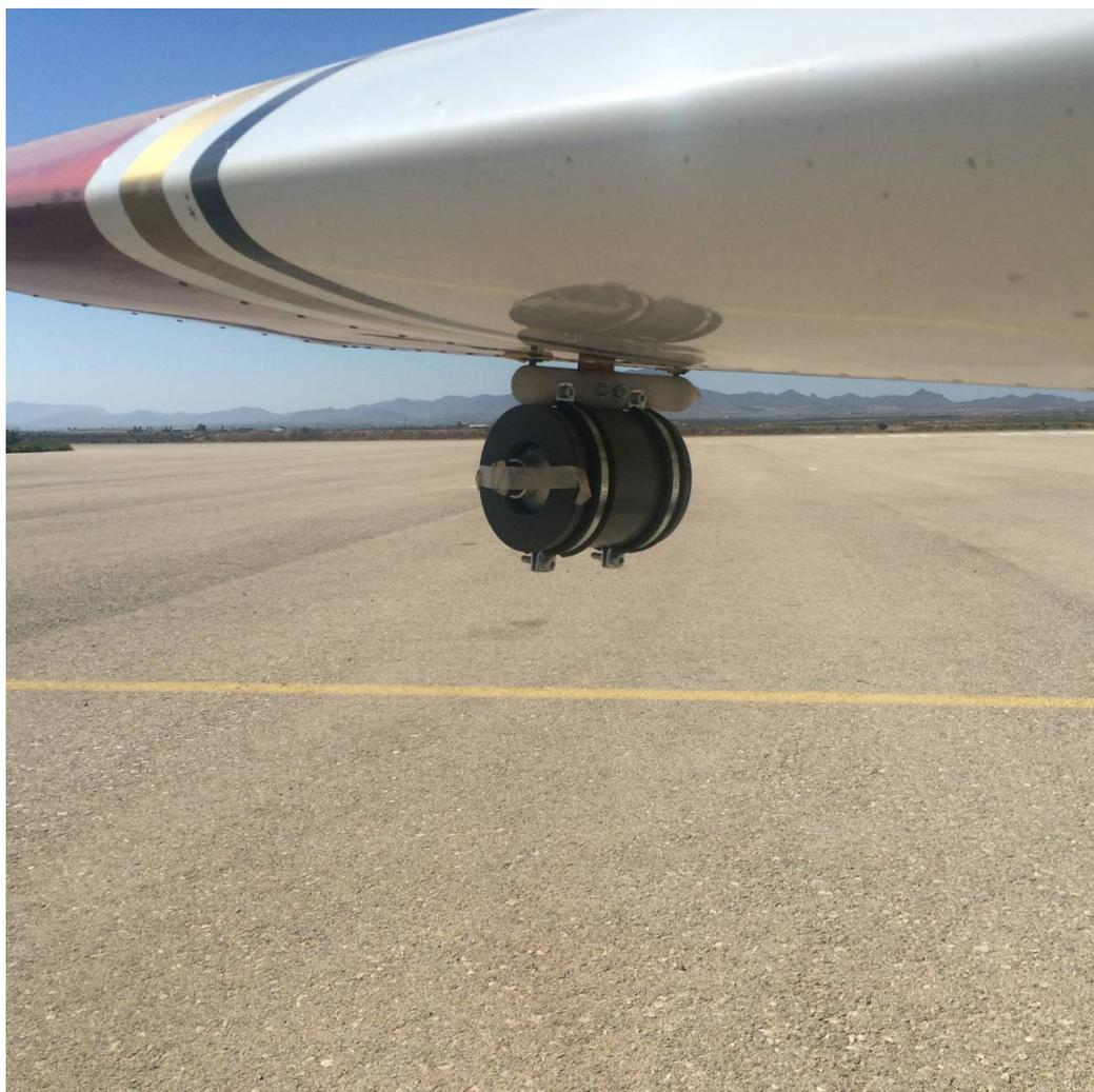
Prototipo del captador de partículas del aire montado en una avioneta. / UPM
