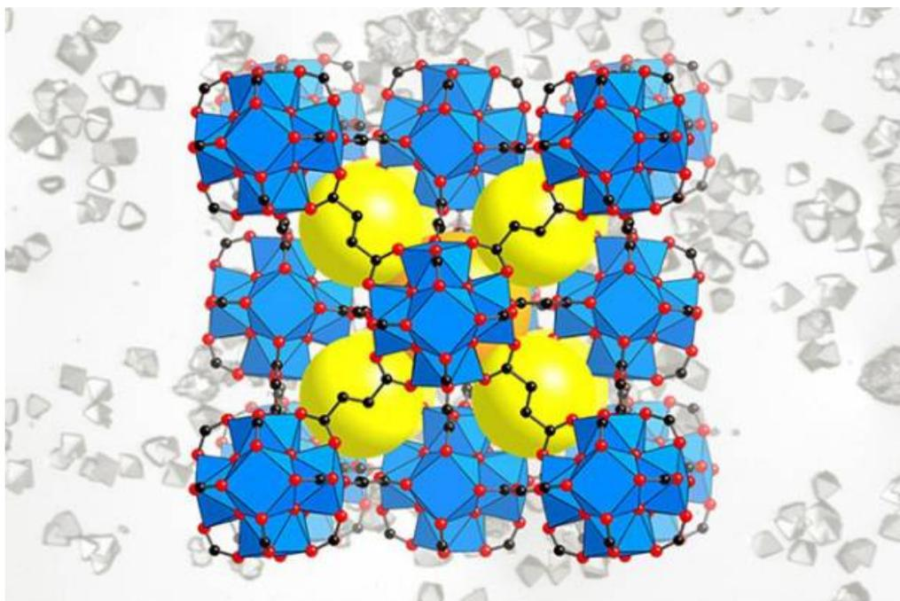
Esquema de un MOF (metal organic frameworks). Las líneas son enlazadores orgánicos, y las intersecciones son iones metálicos. Estos son los bloques de construcción que Yaghi une en forma de esponjas cristalinas usando lo que llama química reticular. Las bolas amarillas representan los espacios porosos que se pueden llenar con gas o líquido. La imagen de fondo muestra cristales MOF individuales en el medio acuoso. / UC Berkeley, Berkeley Lab.
