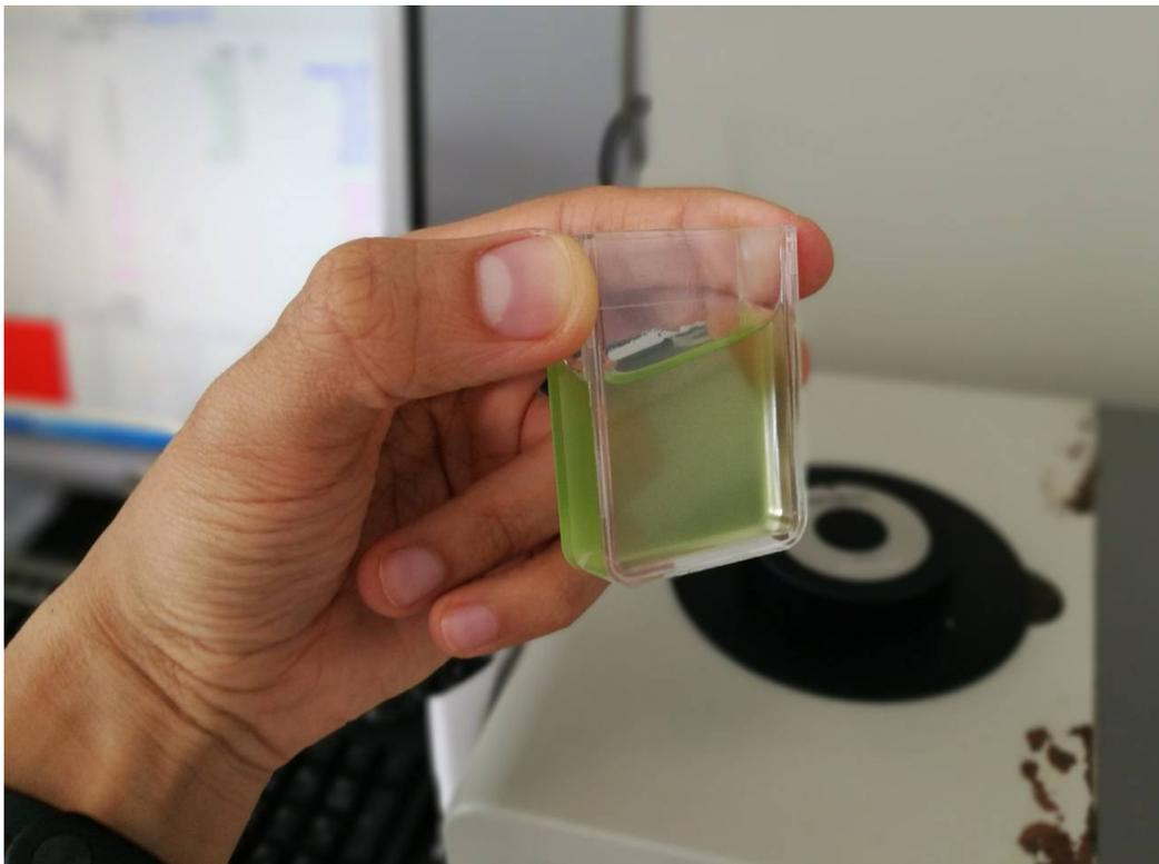
La técnica desarrollada consiste en tomar una muestra de un cultivo de microalgas y, a través de un colorímetro, obtener su huella espectral. En la imagen, muestra lista para medir la huella espectral con el colorímetro. / Blas Franco
