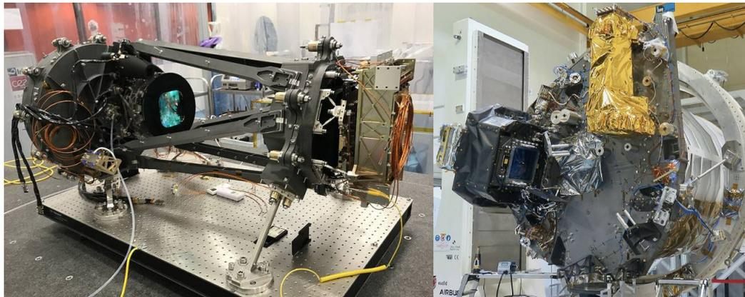
Instrumento NISP (izquierda) e integrado a la derecha (bajo la cubierta dorada) en el módulo de carga útil de Euclid, donde también está el instrumento VIS. / Euclid Consortium & NISP instrument team/Airbus
