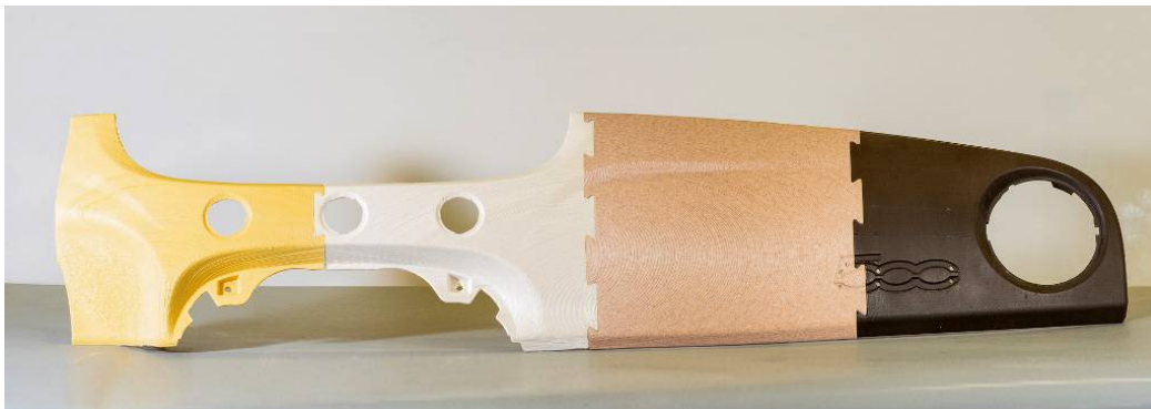
Pieza para el salpicadero de un coche fabricada con esta técnica. / AITIIP
