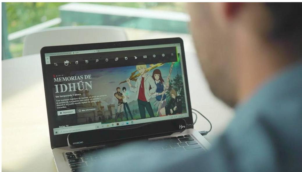
Dispositivo Hiru acoplado a un ordenador portátil para seleccionar opciones sin tocarlo, solo con la mirada. / Irisbond
