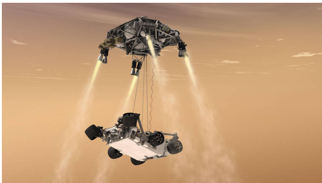
Recreación del sistema de grúas (sky crane) depositando el rover en el suelo marciano. / NASA/JPL
