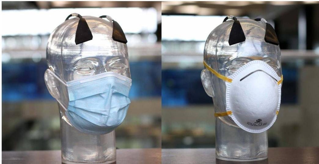
Maniquí con dos tipos de mascarillas utilizados en el estudio, con las sondas biofotónicas en la frente. / ICFO
