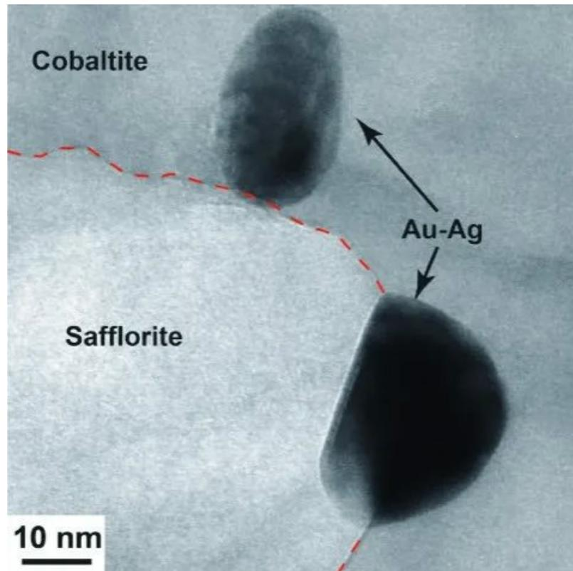
Detalle de la fusión «fossilizada» de dos nanopartículas de oro. La de la derecha está en proceso de fundirse, mientras que la de arriba ya ha fundido completamente, adoptando una forma totalmente redondeada / UB.
