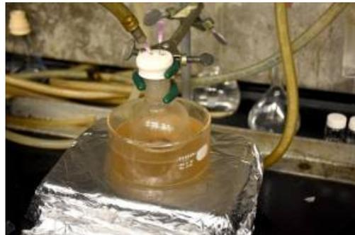
Un frasco lleno de ceras generadas a partir de residuos de polietileno y polipropileno se calienta en un baño de aceite, y las ceras se oxidan mediante una corriente de aire para producir ácidos grasos por oxidación catalítica. / Steven Mackay, Virginia Tech.
