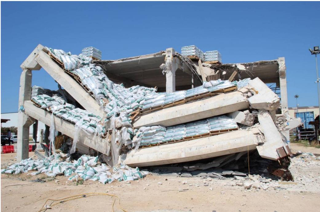
Edificio prefabricado a escala real parcialmente colapsado tras las pruebas. El derrumbe quedó aislado en las zonas inmediatamente adyacentes al gran fallo inicial reproducido durante las pruebas. / Jose M. Adam
