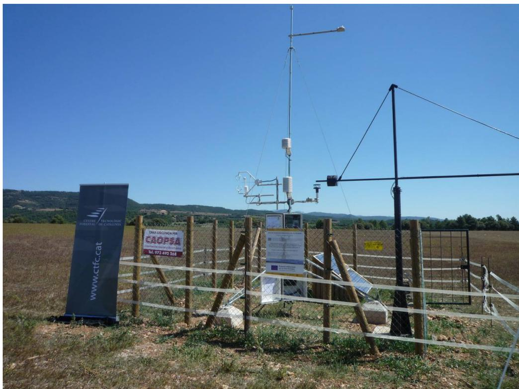
La estación mide, entre otros, la velocidad y dirección del viento, la pluviometría, la temperatura y humedad del aire y suelo, la presión atmosférica, y las radiaciones solares. Foto: CTFC.
