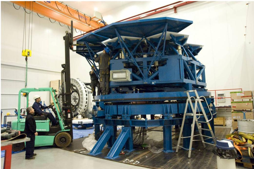
Los ingenieros del Instituto de Astrofísica de Canarias ultimán los detalles antes del que el simulador del espejo primario del E-ELT sea puesto en funcionamiento. Foto: M. Briganti.
