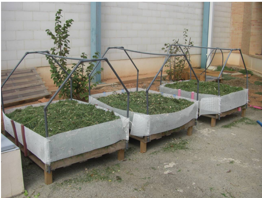
Invernaderos contruidos en la UJI para realizar los ensayos de biosecado. Imagen: UJI.
