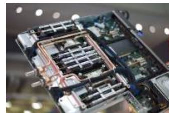
Detalle de la canalización que lleva el agua para refrigerar los procesadores
