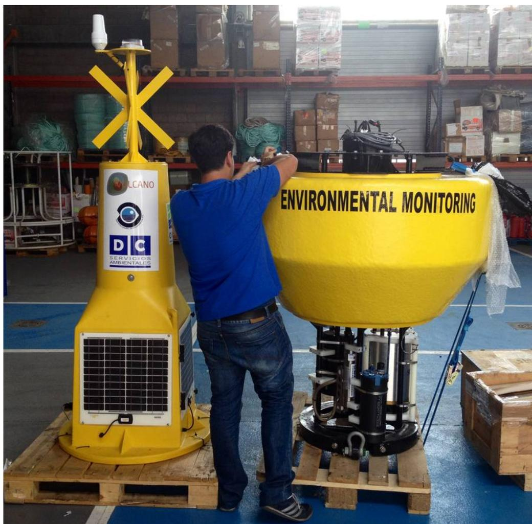
La boya satelital Vulcano es un instrumento flotante de unos cuatro metros de altura y dos de diámetro, que alberga sensores de altísima precisión y resolución para la medición de parámetros. / IEO.
