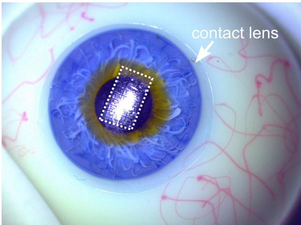
El dispositivo transparente se puede poner en una lente de contacto para medir la presión intraocular en enfermos con glaucoma. / Salvatore et al.
