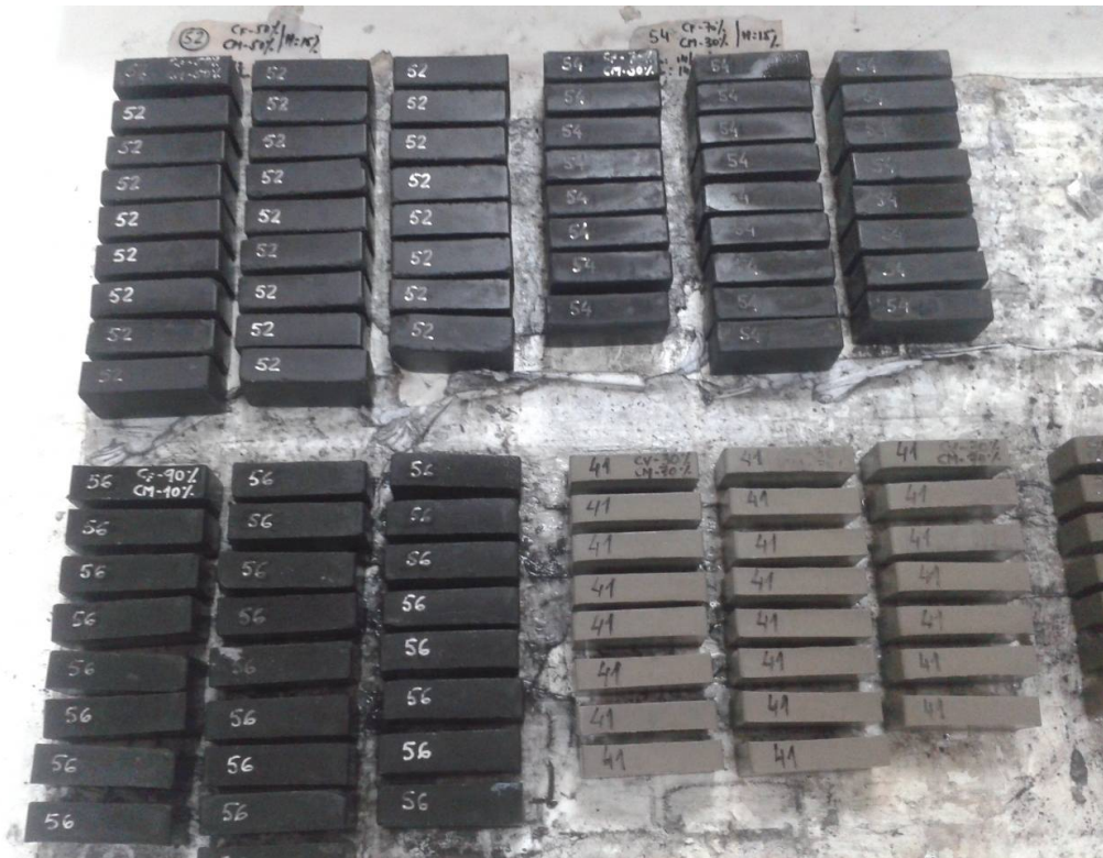
Muestras de bloques con cenizas y cemento / Fundación Descubre
