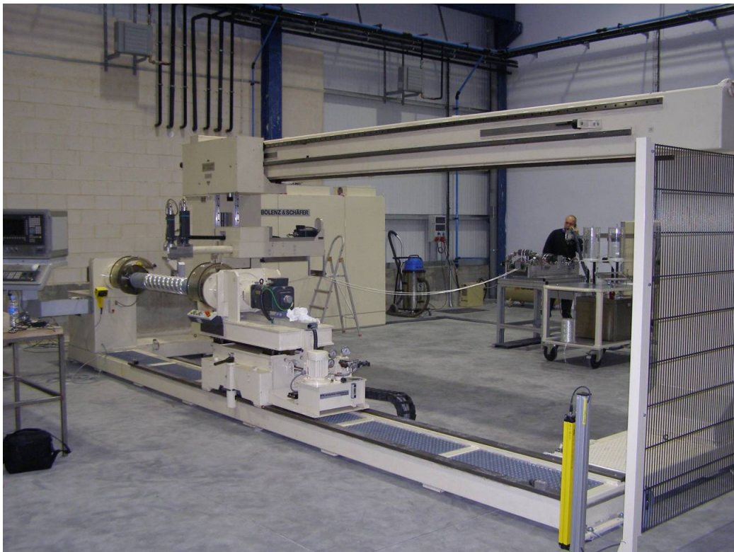
Máquina devanadora instalada en CEDER-CIEMAT.
