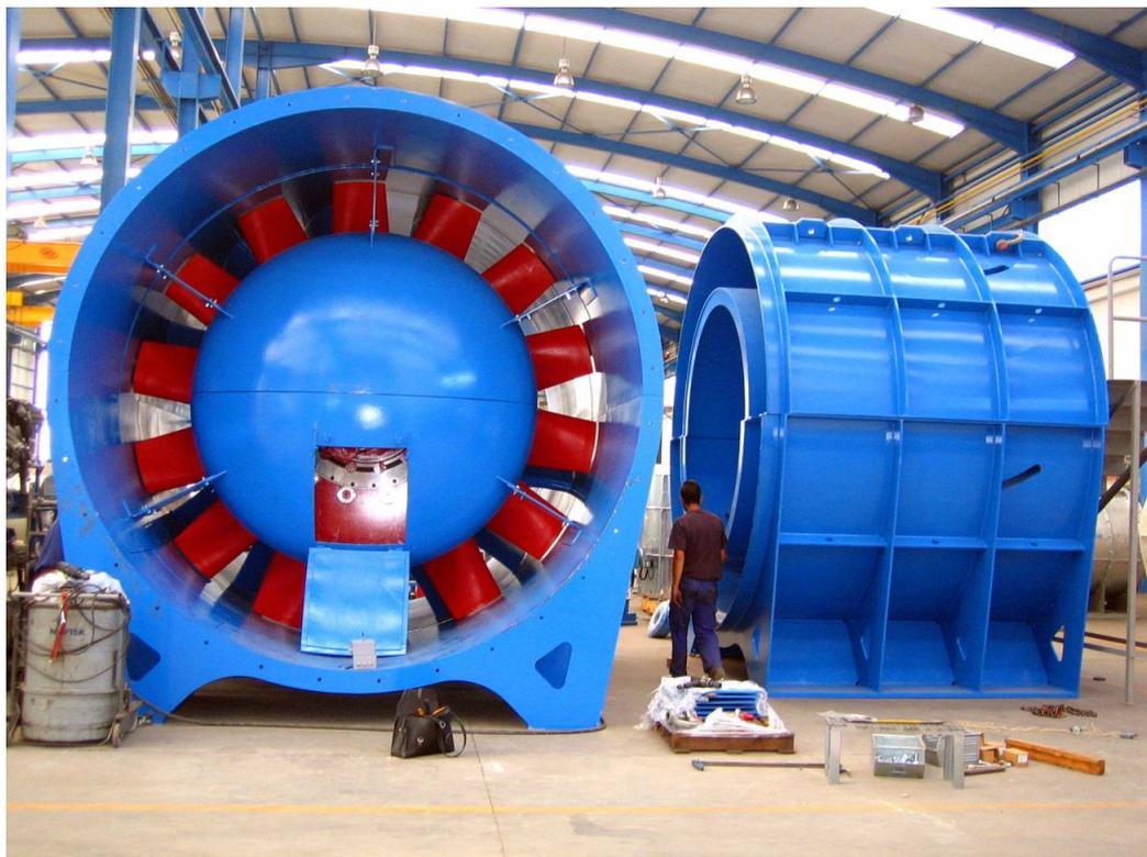
Ventilador de 4,2 m de diámetro para una mina rusa con álabes de fibra de carbono. / Zitrón
