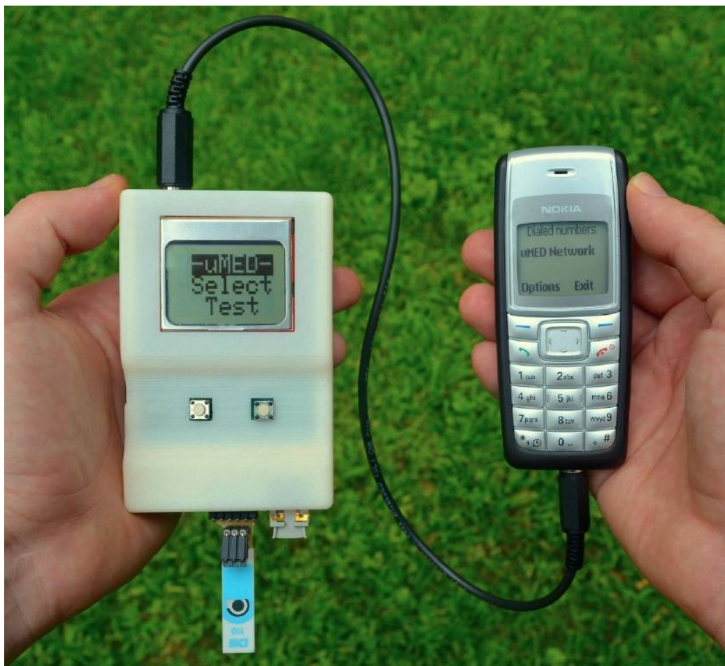
Dispositivo uMED con una tarjeta de electrodos serigrafados DropSens y acoplado a un teléfono móvil. / Uniovi
