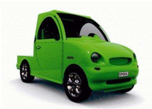
EPISOL: vehículo Eléctrico de Pila de Combustible y Energía Solar. Fuente:UPM
