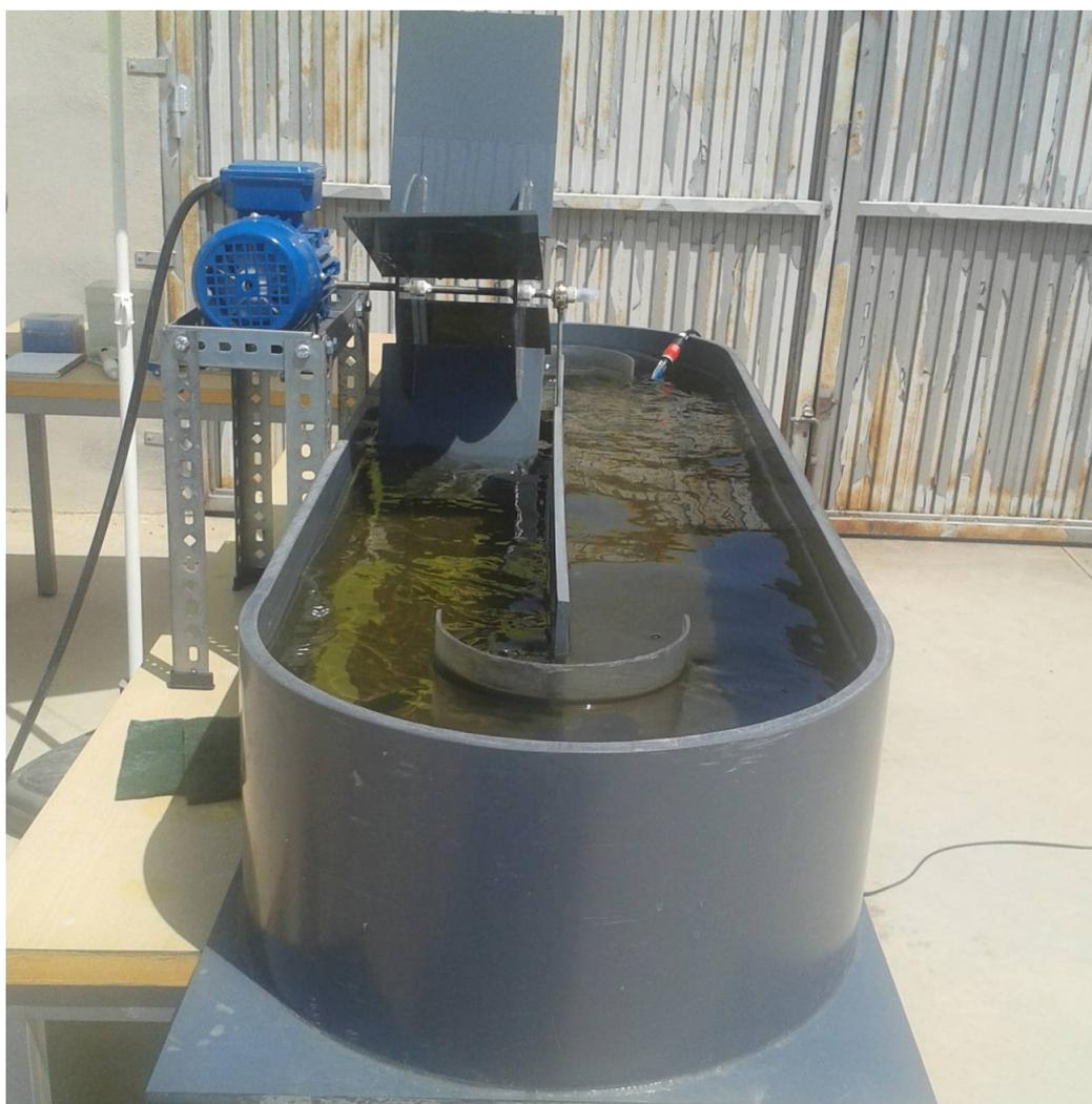
El modelo de reactor *raceway* o de carrusel utilizado para depurar aguas / Fundación Descubre
